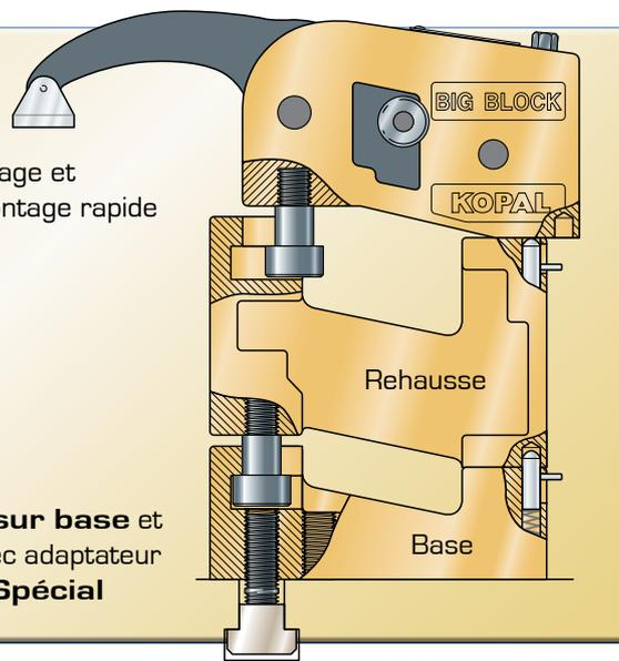
Indexage de la came en 5 positions, pour s'adapter rapidement à la hauteur de serrage.
